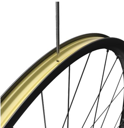
2. Führen Sie den Ventilschaft durch das Felgenband in die Ventilschaftbohrung ein. Schrauben Sie die Mutter auf der gegenüberliegenden Seite der Felge auf den Ventilschaft.
