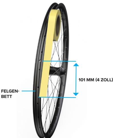
3. Drücken Sie mit dem Daumen das aufgeklebte Ende des Felgenbands fest gegen die Felge. Drehen Sie die Felge vorwärts, sodass sich der freie Teil des Bandes in einer Linie mit dem aufgeklebten Teil des Bandes befindet. Dadurch können Sie die richtige Kraft oder Spannung auf das Band anwenden.
