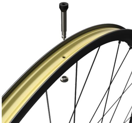
3. Drücken Sie das Gummi-Ende des Ventilschaftes fest in die Ventilschaftbohrung, während Sie die Mutter von Hand festziehen.
