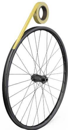
4. Halten Sie das Band gespannt und kleben Sie es auf, indem Sie es in kurzen Abschnitten mit dem Daumen fest auf die Felge drücken. Fahren Sie mit dieser Technik entlang des gesamten Umfangs der Felge fort, bis Sie den Anfang des Bandes erreicht haben (nicht abgebildet).
